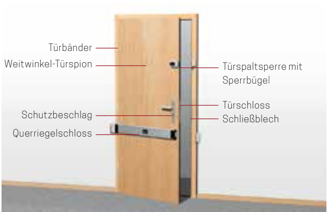
^ Tür mit einbruchhemmenden Nachrüstprodukten
